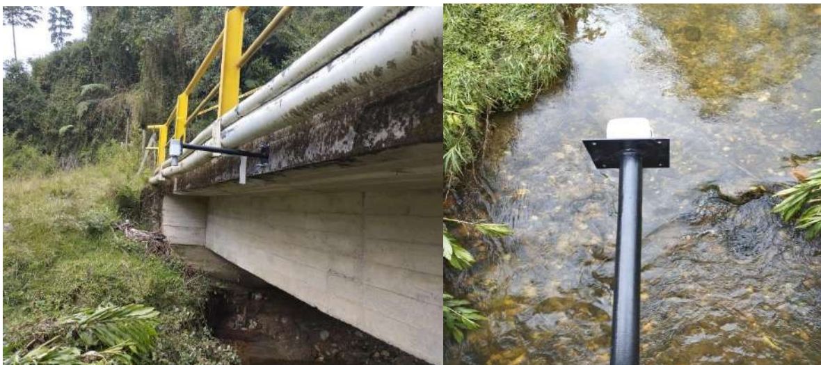
Primer piloto de sensores para monitoreo de aumento en el nivel de los ríos en línea a través de la implementación de una red Lora del tipo LPWAN
